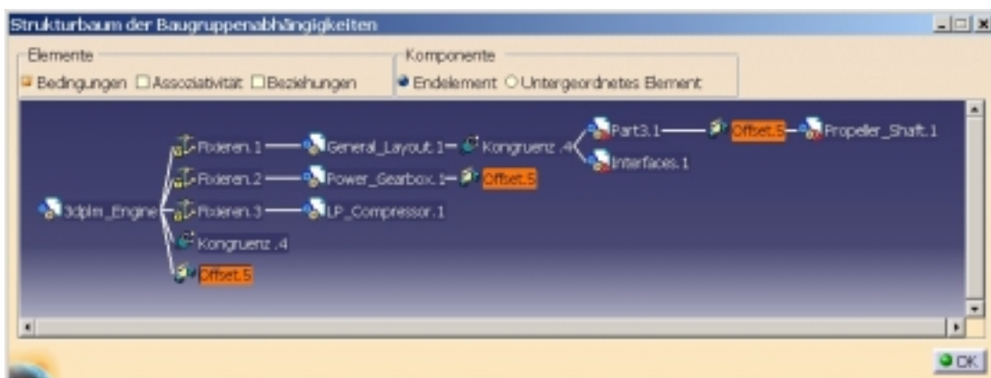
Abb.41: Grafische Darstellung der Randbedingungen im Strukturbaum der Baugruppenabhängigkeiten.
