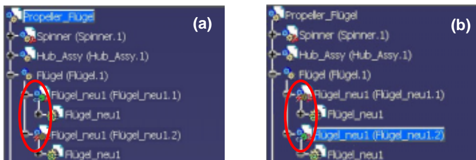
Abb.21: Bauteil (Flügel) mit über Kopieren/Einfügen erzeugter Instanz:
